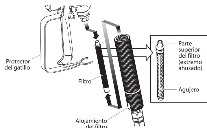
2. Retire el filtro del alojamiento de la pistola rociadora y límpie el filtro con un cepillo y la solución adecuada de limpieza (agua jabonosa tibia para las pinturas látex, alcoholes minerales para las pinturas con aceite).
